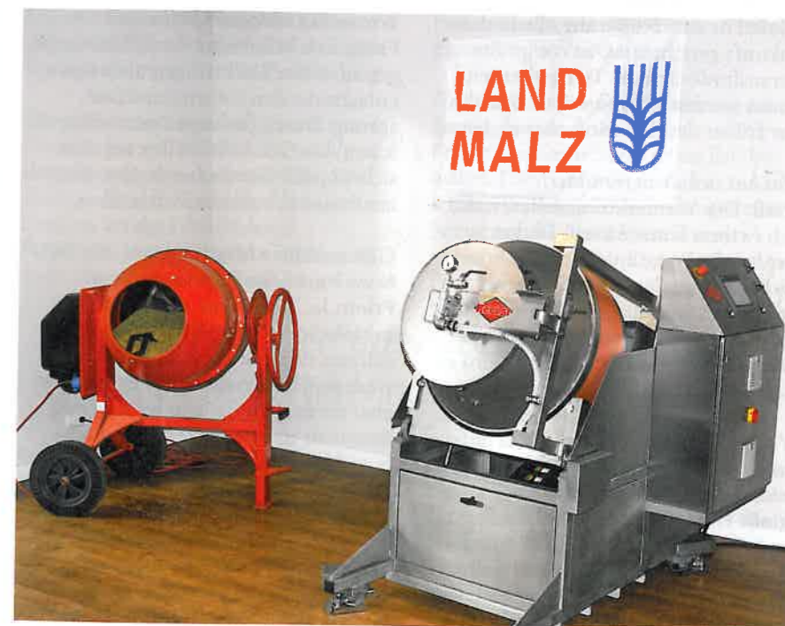
Mit dem Betonmischer (li.) hat Bartmer erste Versuche unternommen. Rechts der Prototyp der fertigen Anlage, die in dieser Ausführung pro Charge 100 kg Malz erzeugt.
